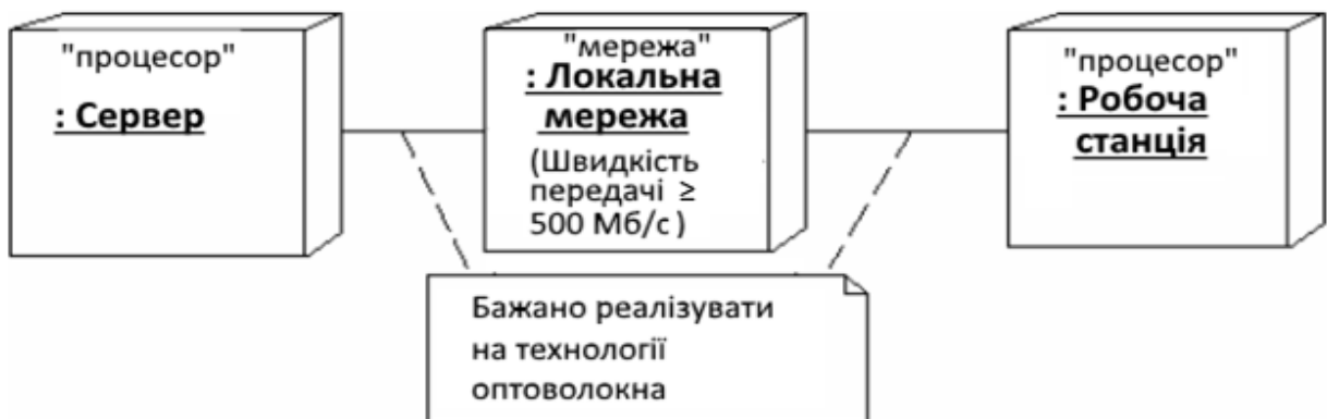
Рисунок 3.53 – Фрагмент діаграми розгортання зі з'єднаннями між вузлами
